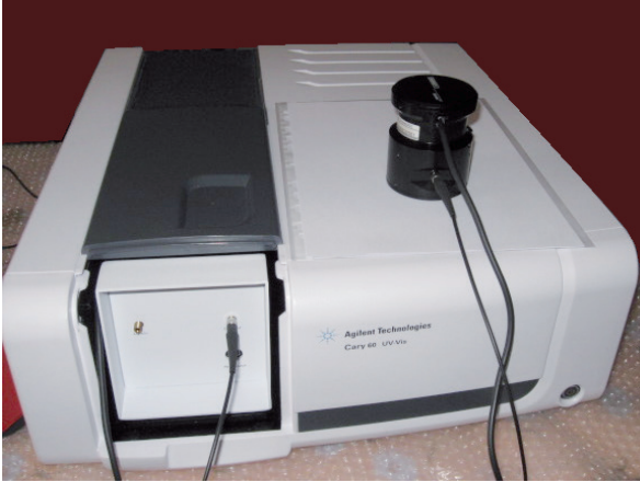
Рисунок 1. Спектрофотометр Agilent Cary 60 UV-VIS с дистанционной оптоволоконной приставкой диффузного отражения (ПДО).
